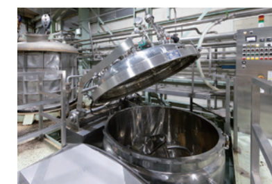
加圧・減圧抽出タンク
